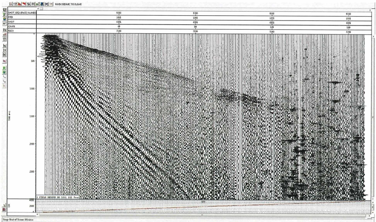
Abbildung 4: Aufzeichnung FFID 1001, Anregungslinie 9300, Dublette mit 6 m Teufe, Gesamtladung 250 g
