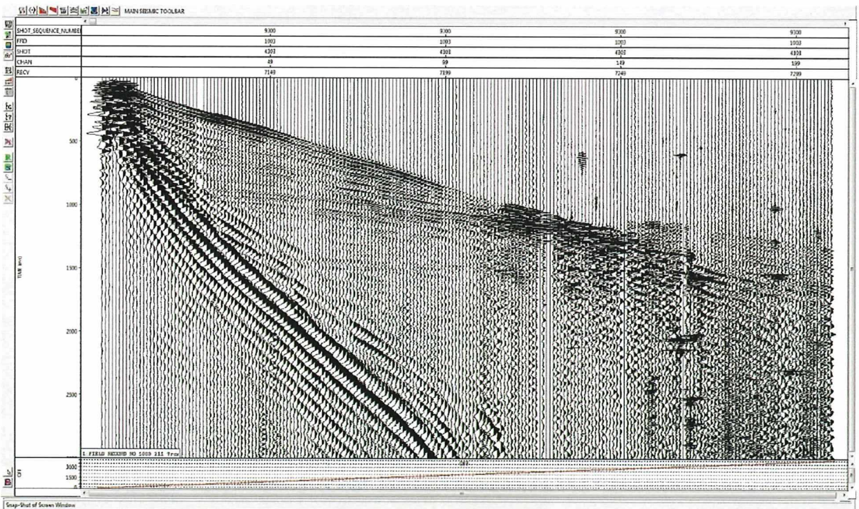
Abbildung 6: Aufzeichnung FFID 1003, Anregungslinie 9300, Dublette mit 6 m Teufe, Gesamtladung 970 g
