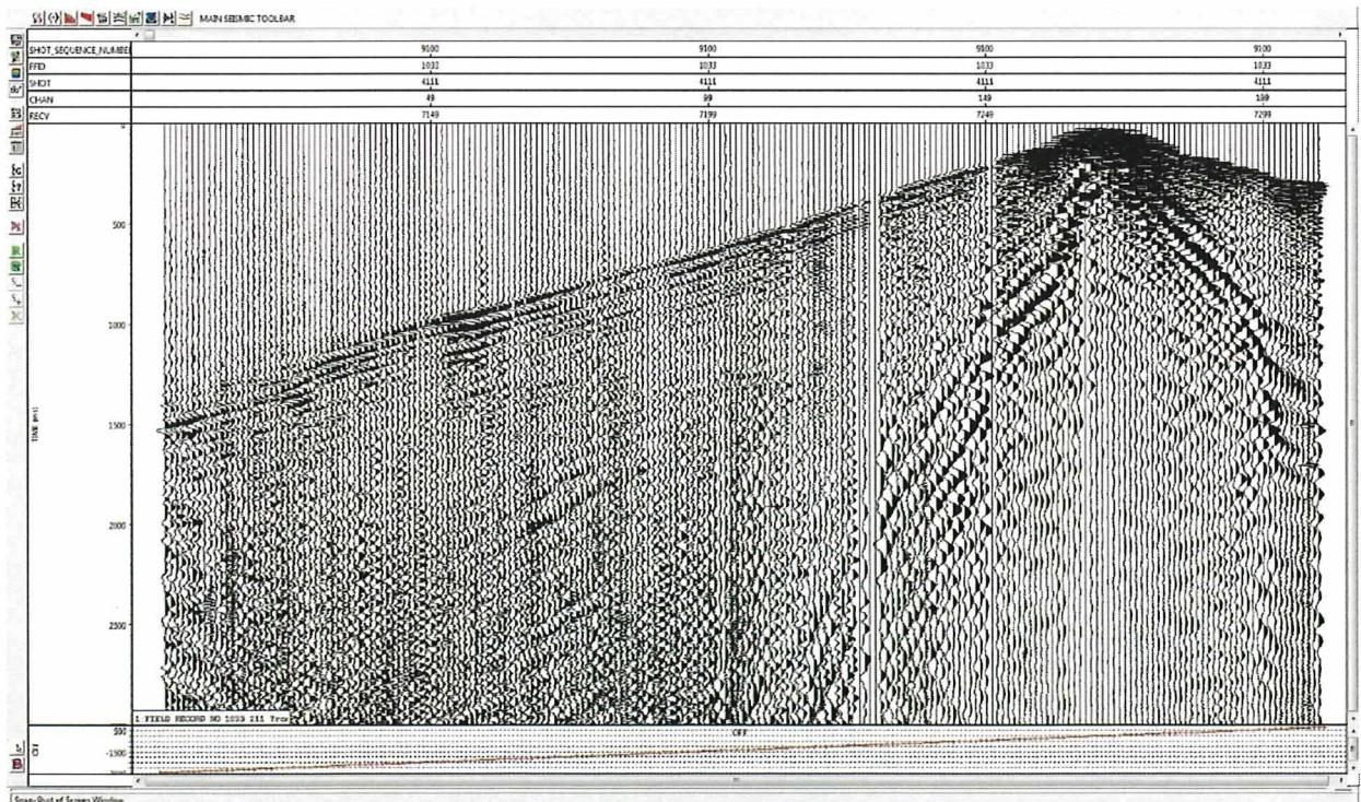
Abbildung 36: Aufzeichnung FFID 1033, Anregungslinie 9100, Einzelbohrung mit 15 m Tiefe, Gesamtladung 970 g
