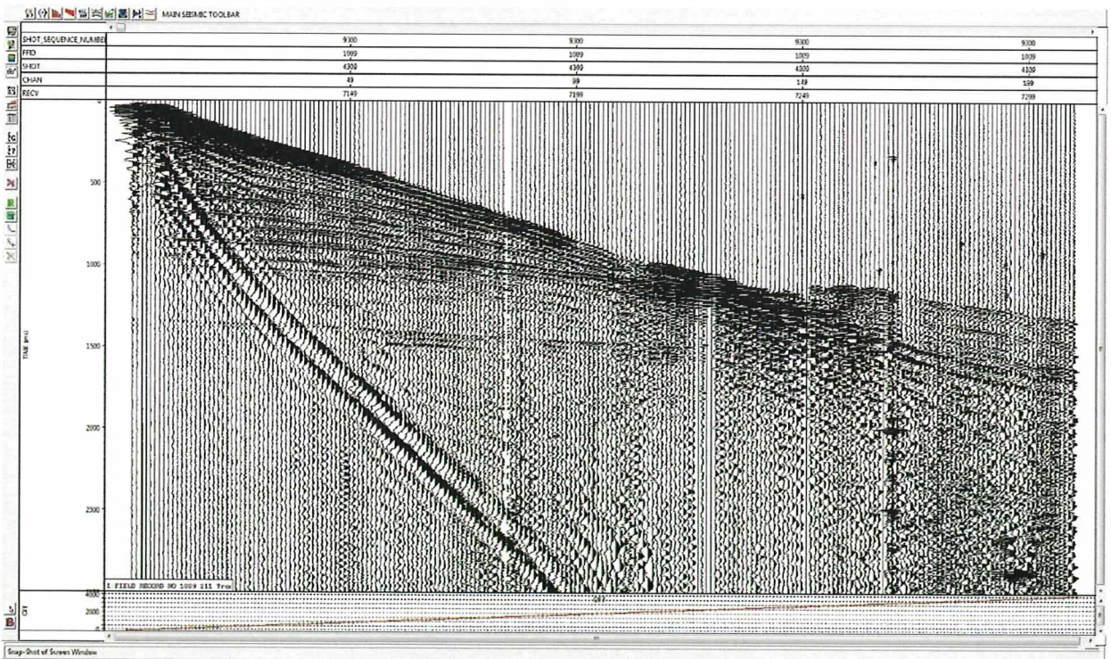
Abbildung 12: Aufzeichnung FFID 1009, Anregungslinie 9300, Einzelbohrung mit 15 m Teufe, Gesamtladung 485 g
