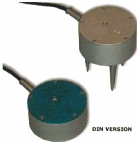
Abbildung 146: Drei-Komponenten-Geophon mit und ohne Spitzen zur Aufstellung
